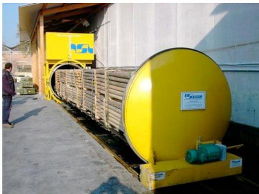
Cette machine d'imprégnation forcée permet le traitement des bois en classe de risque III ou IV. Elle met en œuvre le cycle de Bethell préprogrammé, ou un cycle adapté à votre besoin.
