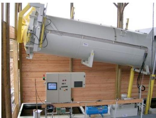
Ecran tactile permettant le pilotage de la machine, la supervision des organes et le contrôle des paramètres du cycle. Traçabilité par enregistrement des cycles sur base de données en réseau, en option.
