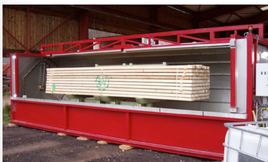
Basculement de la charge à 45°. Fermeture de la machine.
