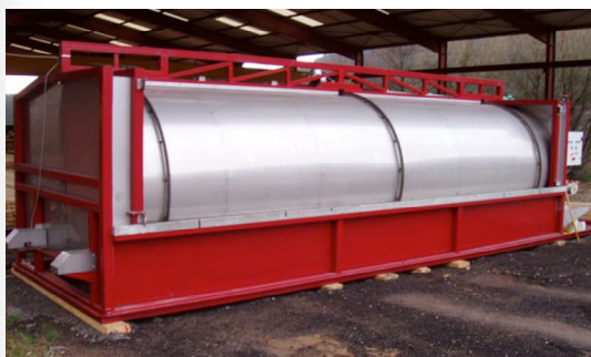
Ouverture de la machine. Basculement de la charge à l'horizontale. Attente d'enlèvement de la charge.
