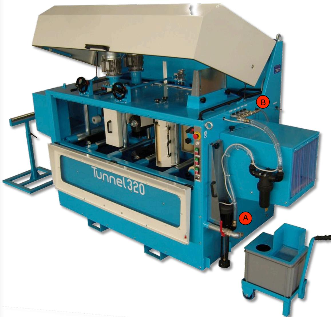
Le **TUNNEL 320** fait partie d'une gamme complète de machines automatiques d'imprégnation destinées aux charpentiers, fabricants de maisons à ossature bois, ainsi qu'à toute activité utilisant des éléments d'ossature en bois.
