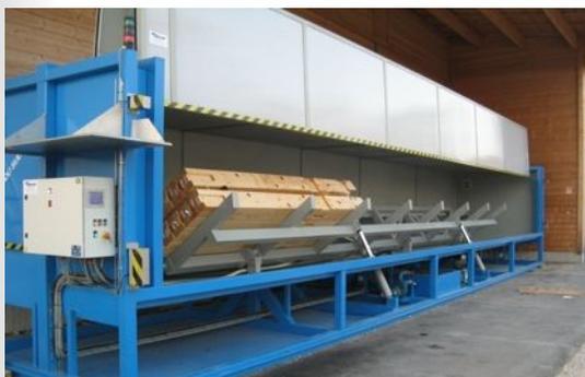
Mise en place des charges à l'aide d'un chariot élévateur et basculement à 45°. Porte en polycarbonate double peau **rigide et isolante**.
